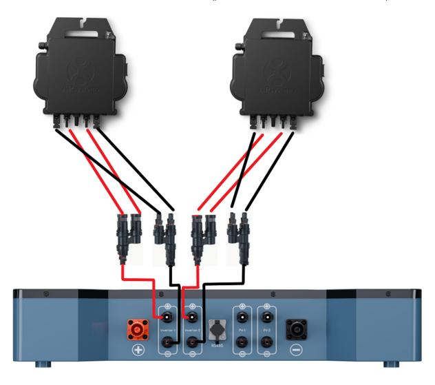
• (Siehe Schaltplan für Details zur Verbindung.- Beispiel Komplettanlage) Hier: 5KWh Anlage mit 10 PV-Modulen und zwei Wechselrichtern, ultra controller und ultra tracker
